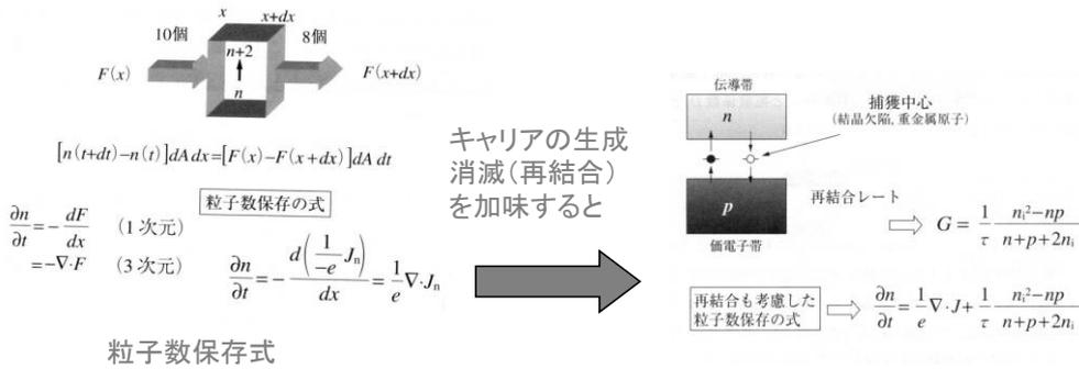
半導体の中でも他の真空中でも金属中でも、マクロな意味では、電流を表す方程式は、電磁気のポアソンの方程式です。つまり、マックスウェルの電磁方程式の一つで  $\nabla \cdot (\epsilon E) = \rho$  です。ρは電荷量です。εEは電束密度で、ρ
