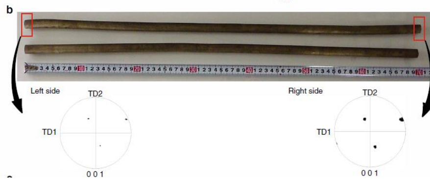
図 1 2 異常粒成長により得られた 70cm 長の Cu-Al-Mn 単結晶ロッド[7]。熱処理さえ工夫すれば、Fe 系でもこのサイズの単結晶を得られる可能性が示されました。
