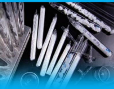
写真の実験器具、実はこれすべて学生さんの手作りなのです。「高温の液体を扱う実験なので、壊すことも多いですが、また新たに作ったり、修理したりするのもお手の物ですよ」。朱研究室において必須のスキル、それがガラス製作技術なのです。
