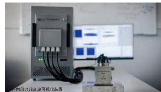
材料内部の超音波可視化装置
