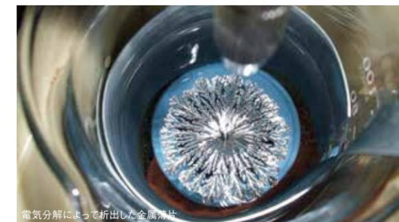
電気分解によって析出した金属薄片
